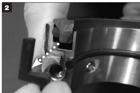
2 古い回転ホルダーガスケットを外します。
