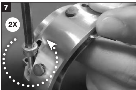
7 ホルダーの二分割片から古いホルダーキャップスクリューを外します。
