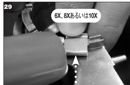
グランドのspring穴にspringを取付けます。プラスチック先端付きの木槌でspringが正しく設置させます。
