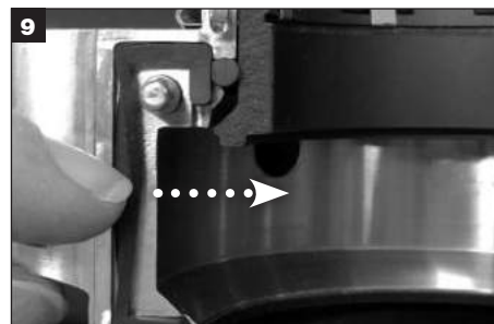
9 古いグランドガスケットをグランドの溝から外します。
