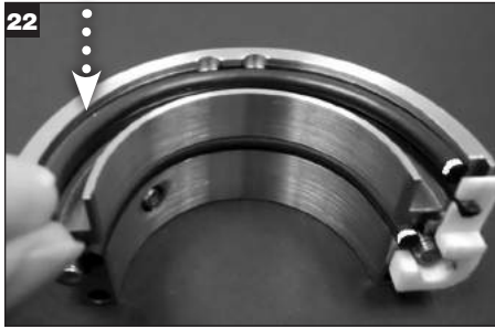
回転環Oリングの両分割片にグリースを薄く塗布し、回転ホルダーの二分分割片に取付けます。
