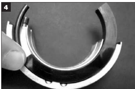
4 回転環の二分割片の先端を押し、回転ホルダーの二分割片からスライドさせて外します。
