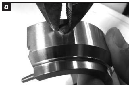
8 回転ホルダーの外径から古いセンタリングボタンを外します。
