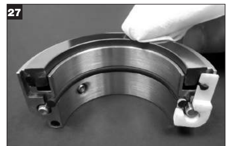
回転環の両分割片をクリーニングワイプで洗浄します。
