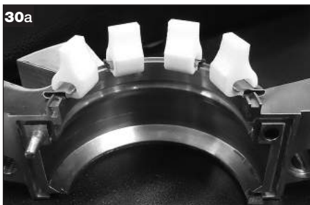
springリフタークリップがグランドの両分割片に取付けられた状態。
